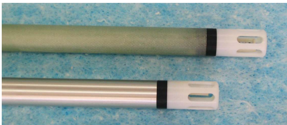
図-6 ガラス繊維強化エポキシ樹脂製センサプローブ(上)とアルミニウム製プローブ(下 標準品)の外観
